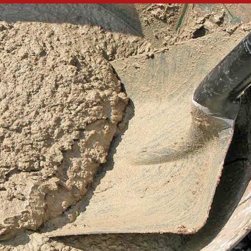
Cal hidráulica natural, de color avellana, obtenida mediante la cocción, en horno vertical en piedra y ladrillos refractarios, a temperaturas inferiores a 1100°C, de calcares de marga seleccionados, de calidad constante, específica para envasar morteros, yesos y soleras de base en las obras de bio construcción y en las intervenciones de restauración histórico y monumental.
